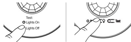
C En el módulo PowPak, mantener presionado el botón **Alternar** “⏻” durante 6 segundos para guardar el vínculo. Las luces titilarán y el LED parpadeará rápidamente durante 2 segundos. **NOTA:** El módulo PowPak saldrá del modo de vinculación automáticamente pasados 10 minutos desde la última actividad. Sin embargo, los dispositivos no responderán hasta que haya transcurrido el tiempo de espera.
