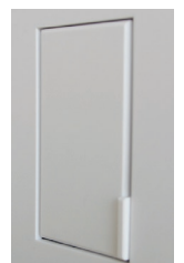
Incorrecto: El atenuador/interruptor está a nivel con la placa frontal. Afloje los tornillos de montaje del control.
