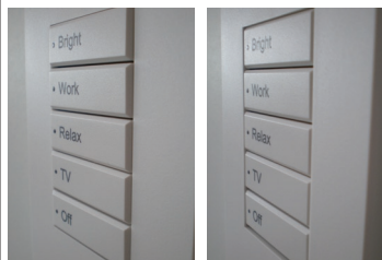
Correcte : Les boutons ressortent de la plaque faciale. Incorrecte : Les boutons effleurent la plaque faciale. Desserrer les vis de montage de la commande.
