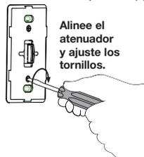
Alinee el atenuador y ajuste los tornillos.
