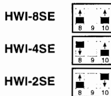
Figure 5 : Commutateurs DIP réglés à l'usine (ne pas modifier)
