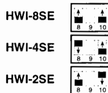
Figura 5 - Microinterruptores ajustados en fábrica (No modificar)
