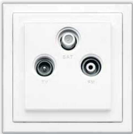
电视电台信号三孔插座 - 中转 5-2300 MHz, 损耗 ≤ 7 dB (阔x高x深) 86.1 x 86.1 x 21mm
